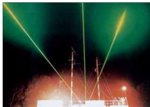
Lidar, faisceau laser pour l'étude des phénomènes atmosphériques.
